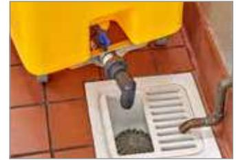
机动排放弯管可根据需要安装在任何方向。可根据地漏排水情况, 选择使用或不使用排水软管。
