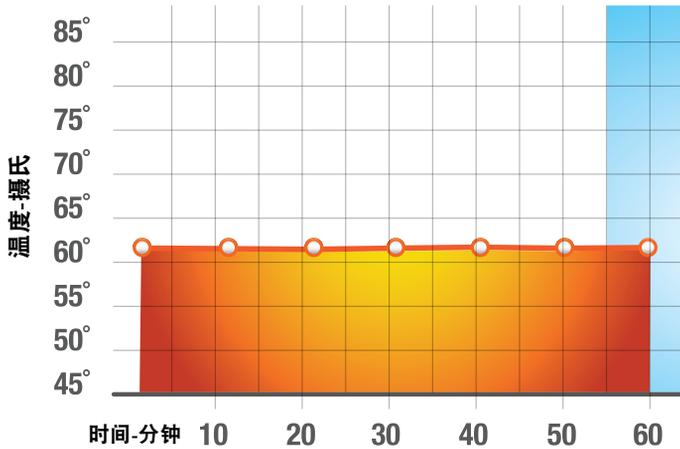
上述结果基于盘碟温度加热到90°-100°C，且热食温度约为85°C的条件下。
