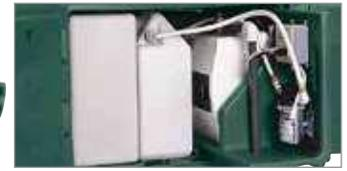
热水器与水泵的最大工作电流分别为11.25 A和0.7 A。洗手池车电力系统平均工作电流为10 A。
